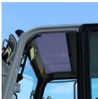
Tettuccio trasparente con tendina parasole.
